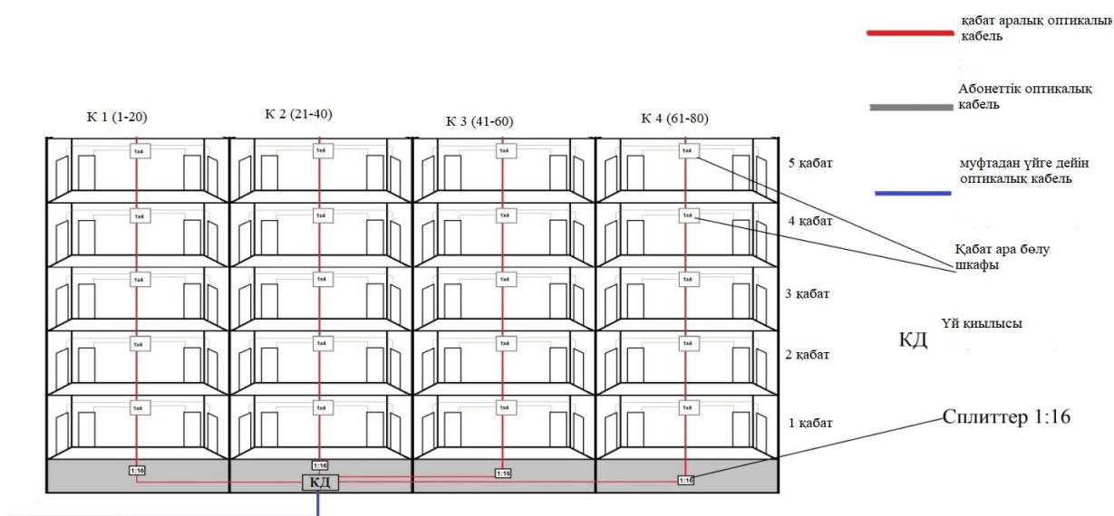
Сурет 3.1.1 - FTTH үй желісін тарату жүйесі.
