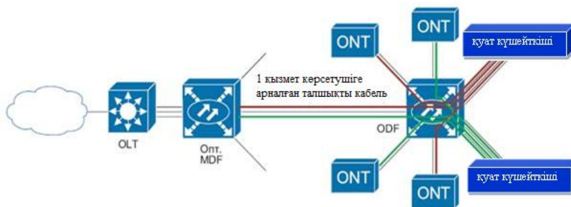
Сурет 1.3.2-Жұлдызды топологиямен Ethernet FTTH сәулеті PON негізіндегі сәулет
